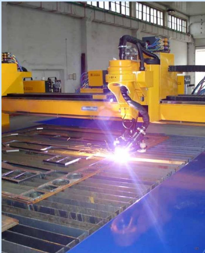
Столичне підприємство, що випускає залізничні вагони та їх комплектуючі, впровадило технологічні зміни з метою зниження енергоспоживання та підвищення продуктивності виробництва. Було здійснено заміну процесу газової різки металу на плазмову різку з використанням сучасного устаткування.
